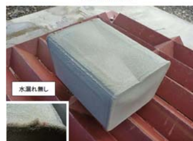
5mm塗装の損傷状況
