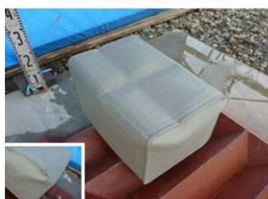
3mm塗装の損傷状況
