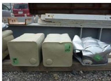
試験後の試験体(左:15mm、中:3mm、右:未塗装)
